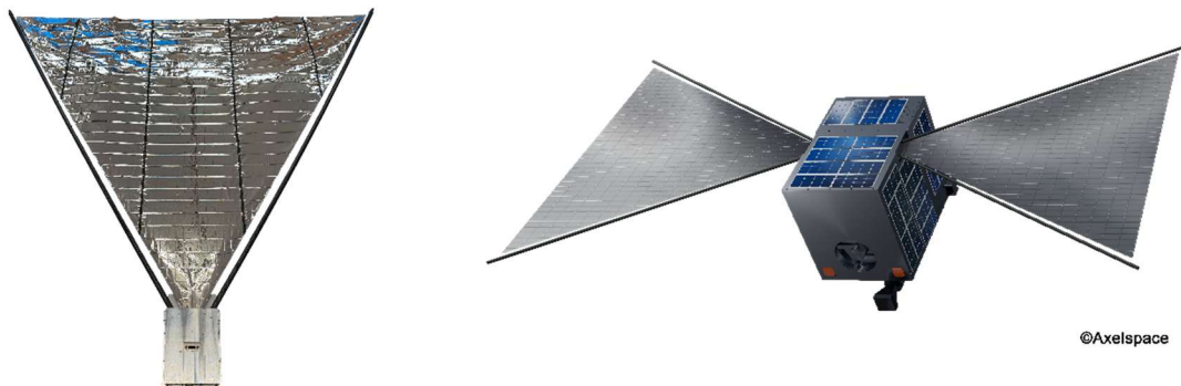
膜面展開型デオービット機構（D-SAIL）の写真（左）と GRUS-3 での膜面展開時のイメージ画像
